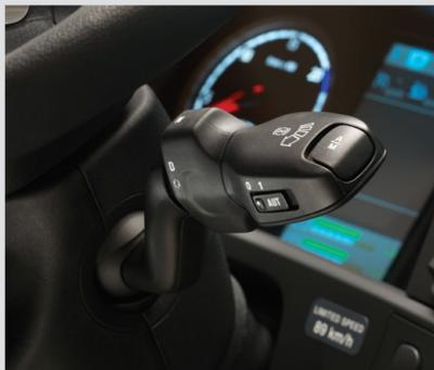
**Scania Opticruise** - автоматизированная система переключения передач, которая поднимает стандарты мастерства и комфорта управления автобусом на новый уровень.
