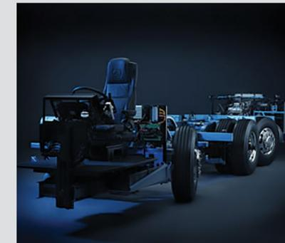
**Самоходное шасси** — основа транспортного средства, обеспечивающая надежную и эффективную эксплуатацию. Модульная конструкция шасси Scania серии К предоставляет возможность выпускать как туристические, так и междугородние автобусы. Каждое из этих решений характеризуется одинаково высоким уровнем комфорта, надежности, безопасности и экономичности при эксплуатации.
