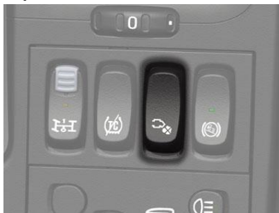
Приведение в действие ограничителя образования белого дыма.
