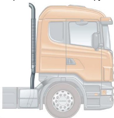
Отвод отработавших газов, направленный вверх. (04099)
